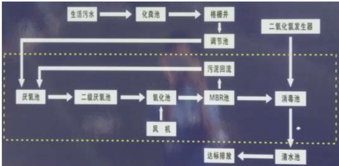
图 4-1 旅游营地污水处理站工艺流程图
